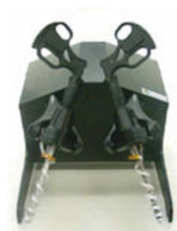
FIGURA 2-14: ESTAÇÃO PARA SIMULAÇÃO DE CIRURGIA LAPAROSCÓPICA (IMMERSION MEDICAL, 2003).
