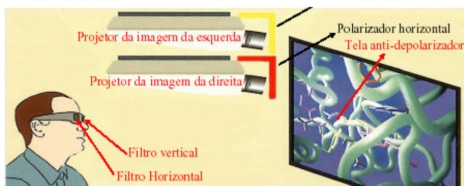
Figura 4 – Funcionamento do método de polarização da Luz(SICOUTTO et al , 2004)
