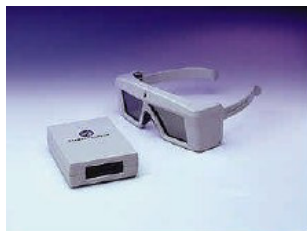
Figura 5 – Óculos obturador sincronizado(SICOUTTO et al , 2004)
